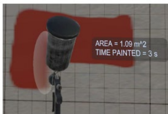
Рис. 21. Модель краскопульта и расчетная функция
